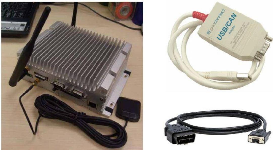
Figura 4. 2 Dispositivo di bordo utilizzato, comprensivo di GPS, Wi-Fi, GSM e interfaccia CAN
